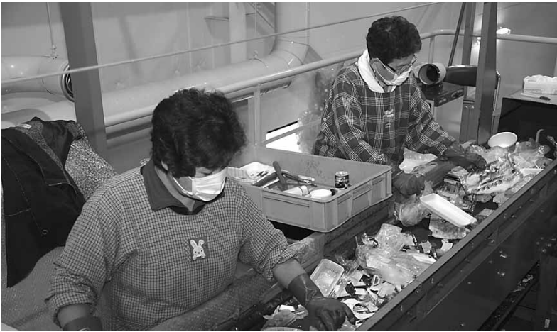
機械に乗ってくるゴミから正しく分別されていないゴミを取り除く。これらはすべて手作業で行われている。
